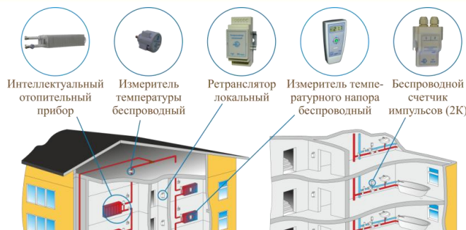
Интеллектуальные системы контроля и регулирования расхода энергоносителей
